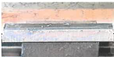
アセチレン切断面 (粗さ：Ra6.992μm Rz41.014μm)
